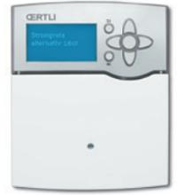
Die CetroCal steuert das FlexHybrid so, dass die Wärmepumpe immer dann in Betrieb ist, wenn diese die Wärme preiswerter bereitstellen kann, als der vorhandene Heizkessel. Die Regelung berücksichtigt Strom, Gas- und Ölpreise, Nachstrom- sowie spezielle Wärmepumpen-Tarife, den Jahreswirkungsgrad des Kessels, die Außen- und Speichertemperatur sowie ggf. den mittels einer Photovoltaik-Anlage preiswert erzeugten Strom.
